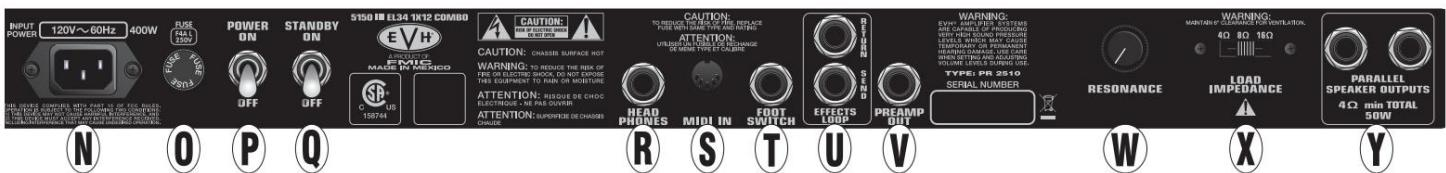
**N. ULAZ NAPAJANJA:** Ovdje spojite priloženi kabel za napajanje na pojačalo, u skladu s naponom i frekvencijom navedenim na stražnjoj ploči pojačala.
